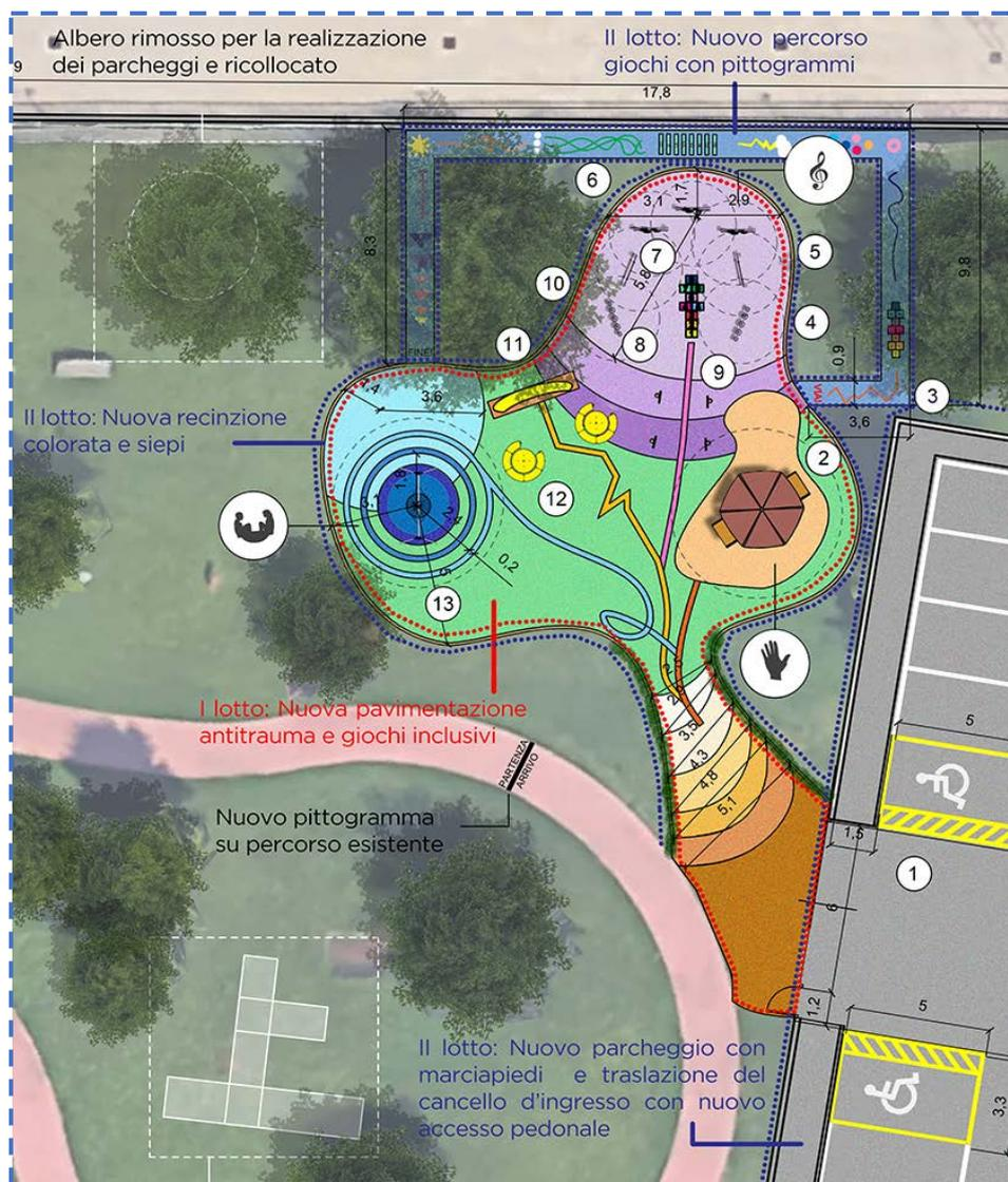
Figura 8 - Planimetria di progetto in cui è possibile vedere la pavimentazione colorata e le dimensioni degli spazi per l'accessibilità. Estratto Tav.03\_Planimetria generale\_sdp
