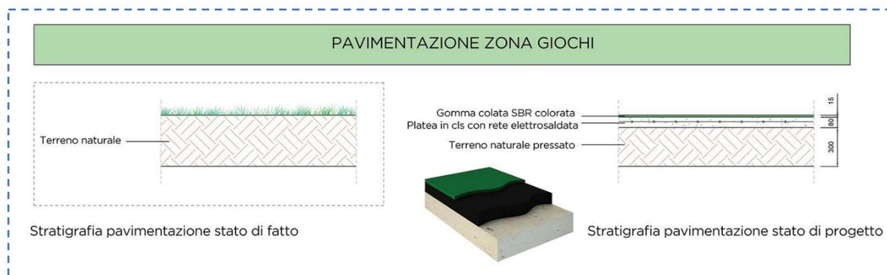
Figura 11 - Dettaglio della nuova pavimentazione. Estratto Tav.3.1\_Dettagli costruttivi\_sdp.
